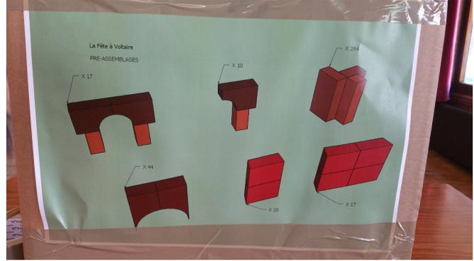
Images réalisées sur Google Sketchup : la structure se présente sous la forme d'un assemblage de modules en carton.
